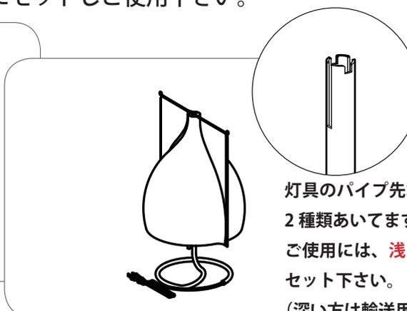
灯具のパイプ先端にはスリットが2種類あります。ご使用には、**浅い方のスリット**にセット下さい。
